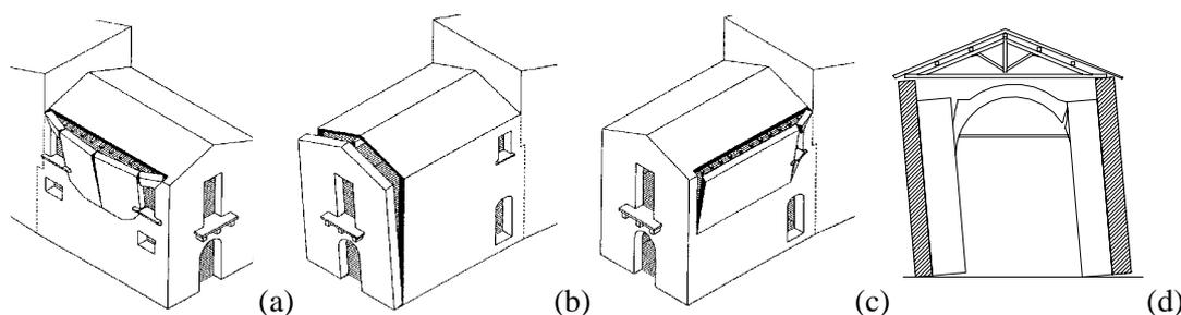
Figure 1 : (a,b,c) Wall overturning (De Benedectis et al.,1993); (d) rocking of transverse arch pillars.
