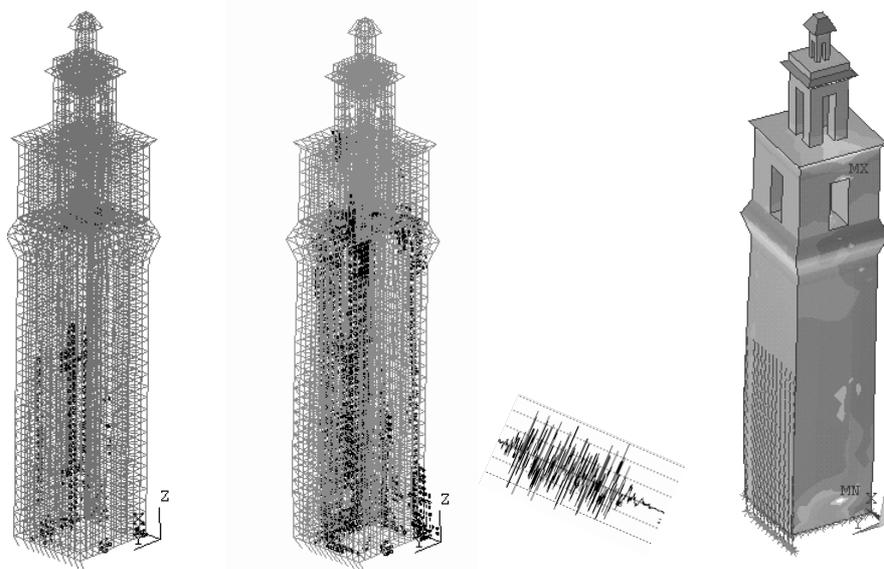
Figure 9 : Crack pattern. 1.4 s, 1.6 s, 2.0 s.
