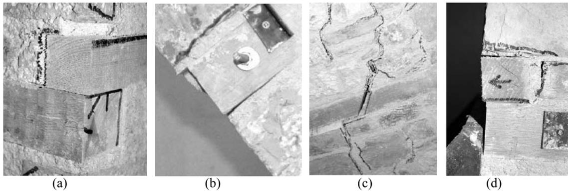
Figure 7 : Details of crack pattern, (a) wallette 5, (b) wallette 6, (c) wallette 7, (d) wallette 8.
