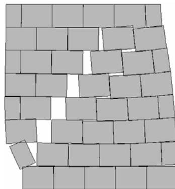
(d) Incremental deformed shape at collapse (250 kN)
